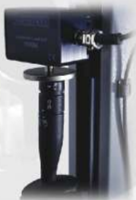
siła lub moment przełączenia dźwigni
