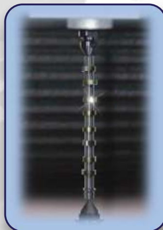
Opcja pomiaru zarysu krzywki wykorzystywana przez producentów wałków rozrządu:
