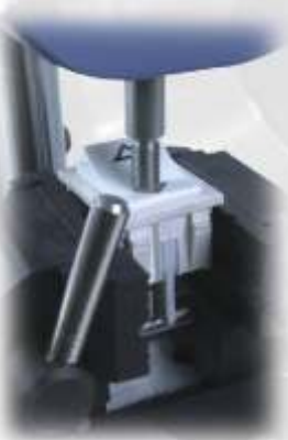
siła przełączania stanu przełącznika
