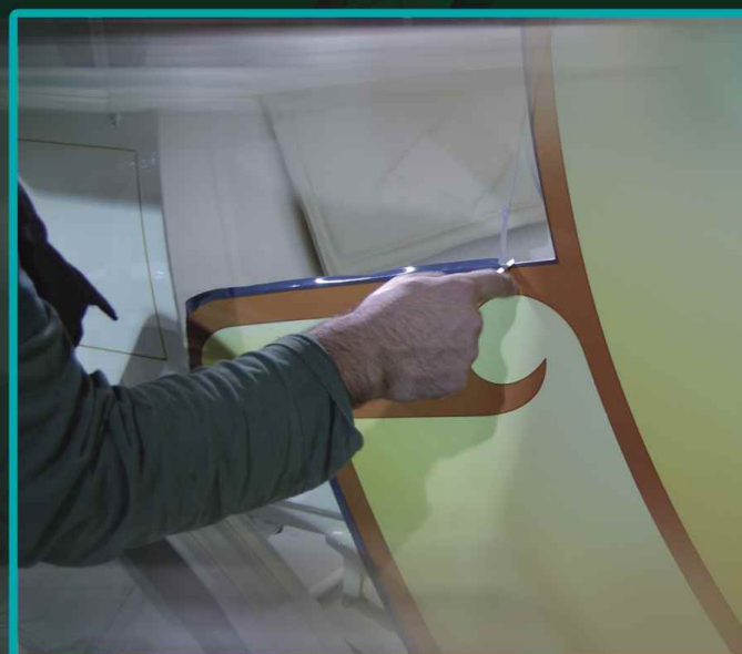
Brązowy element obrysowy musiał idealnie pasować do obrysu kabiny pasażerskiej.
